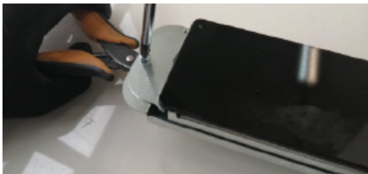
Fig.6 - Svitare le due viti del gruppo comando
